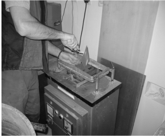
Slika 1. Ugradnja cementnog maltera u kalupe za prizme Figure 1. Embedding cement mortar in molds for prisms
